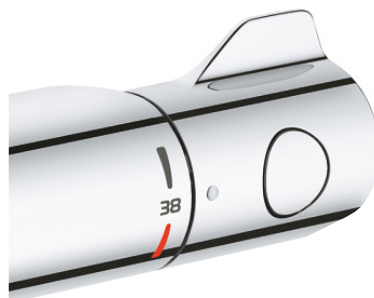
Figure 4 : Exemples de mitigeurs de douche avec limitation mécanique de la température de sortie à env. 38 °C, qui ne peut être débloquée que par une pression sur le bouton.
