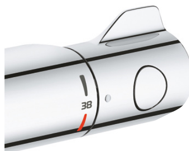
Figura 4: esempio di un miscelatore termostatico con limitazione meccanica della temperatura di uscita dell'acqua a circa 38 °C, disattivabile solo premendo un pulsante.
